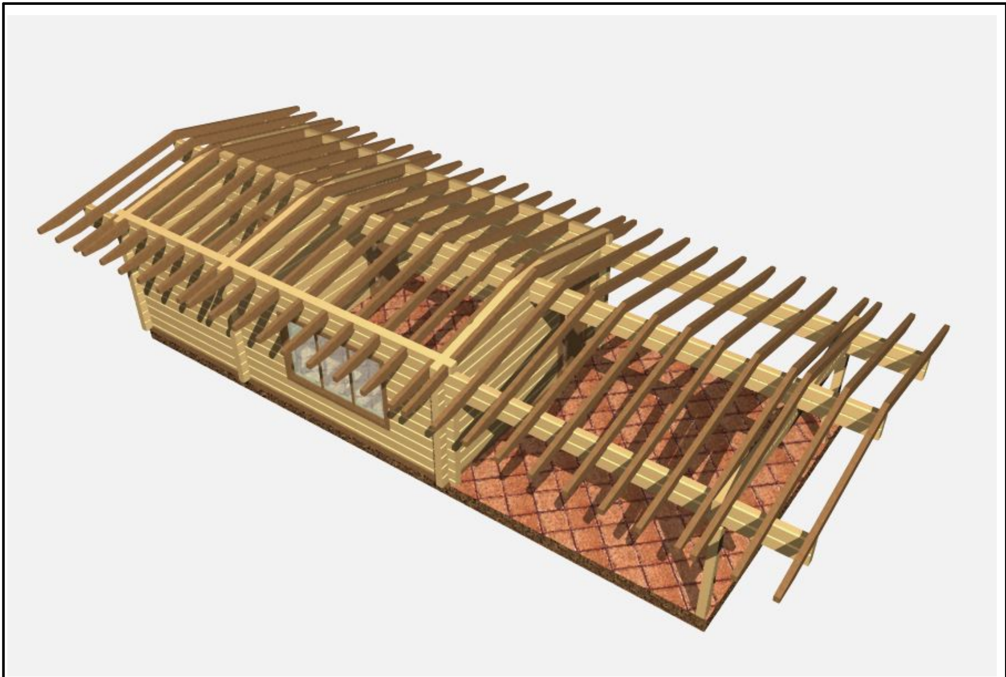
Вид расположения стропильных балок крыши
